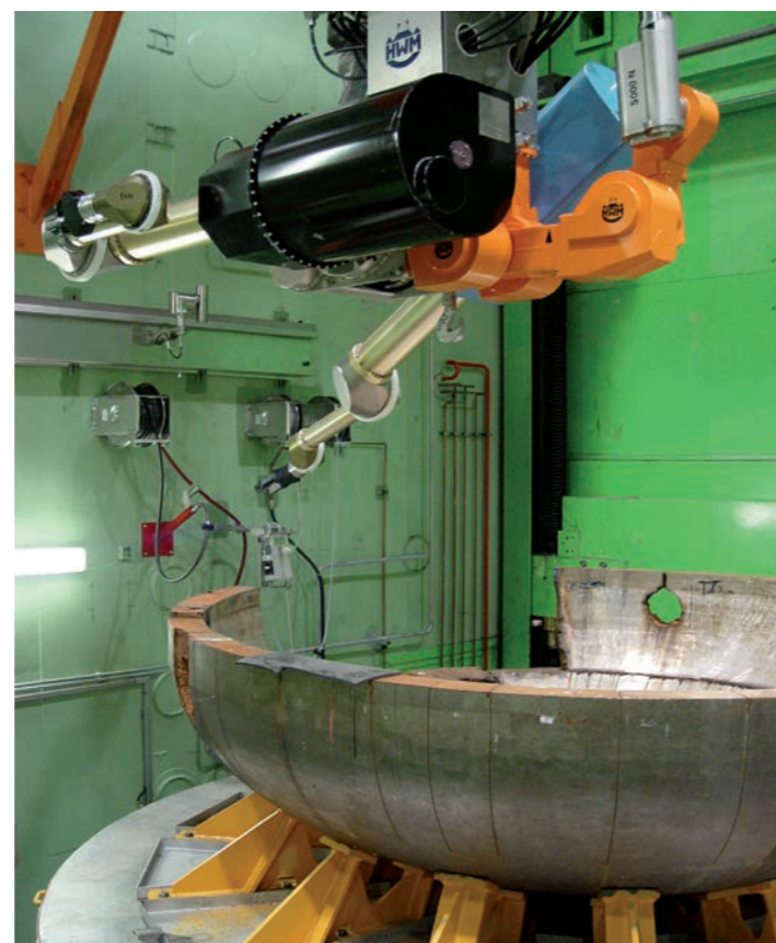
Abb. 29b: Kammer zur Trockenzerlegung
