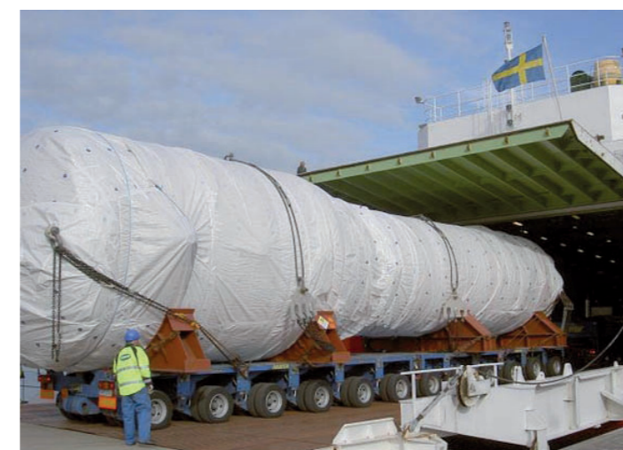
Abb. 30: Transport eines Dampferzeugers nach Schweden zum Einschmelzen
