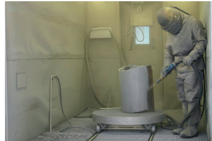
Abb. 16: Dekontamination mittels Sandstrahlen
