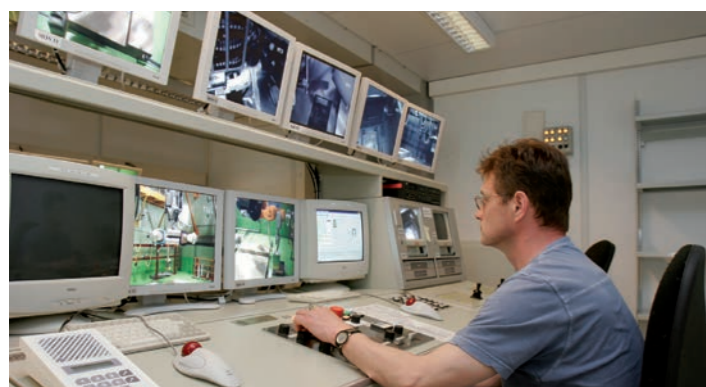
Abb. 29a: Steuerstand für fernbediente Arbeiten
