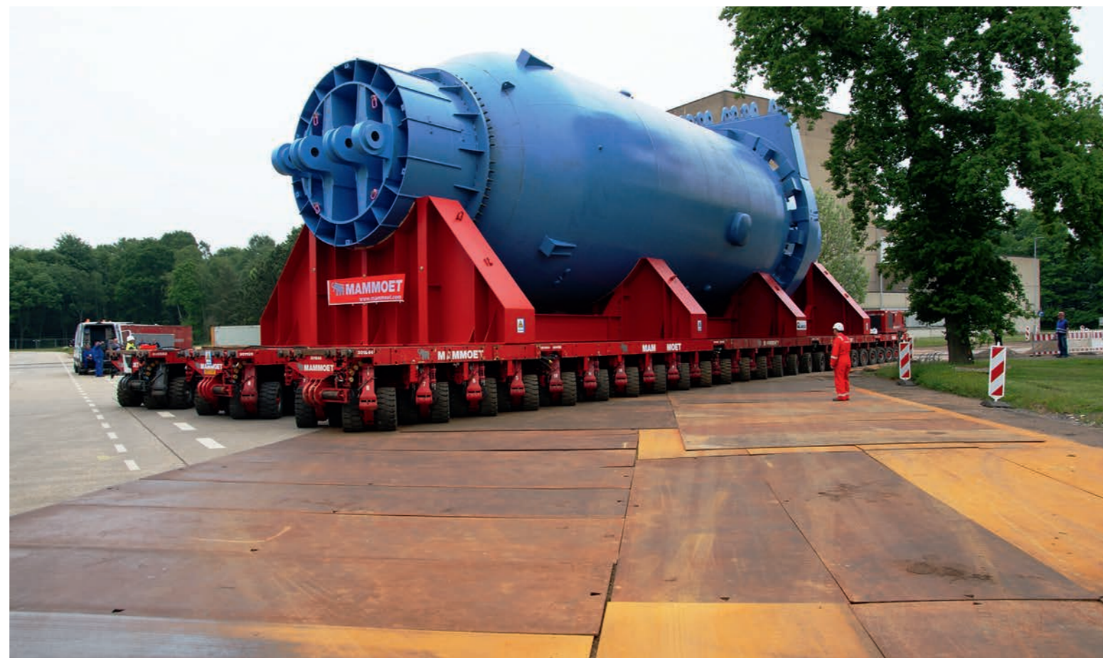
Abb. 47: Transport des AVR-Reaktorbehälters zum Zwischenlager
