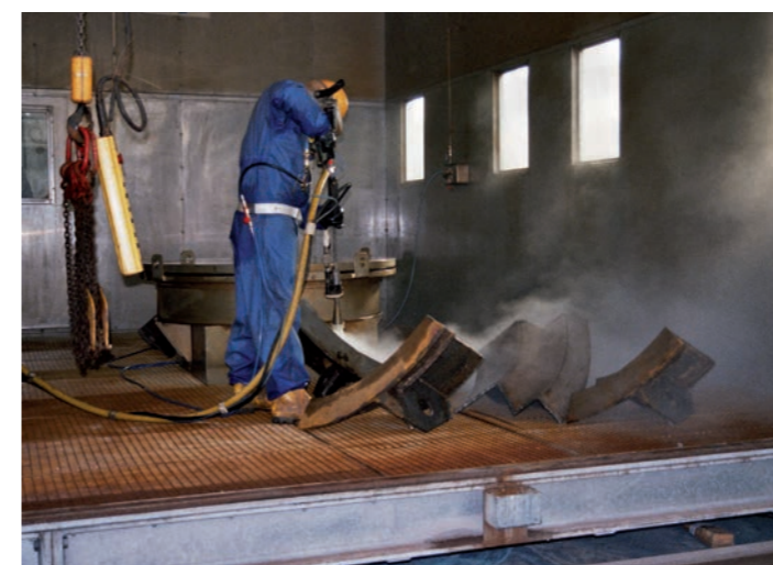
Abb. 26: Dekontamination mit Wasserstrahl
