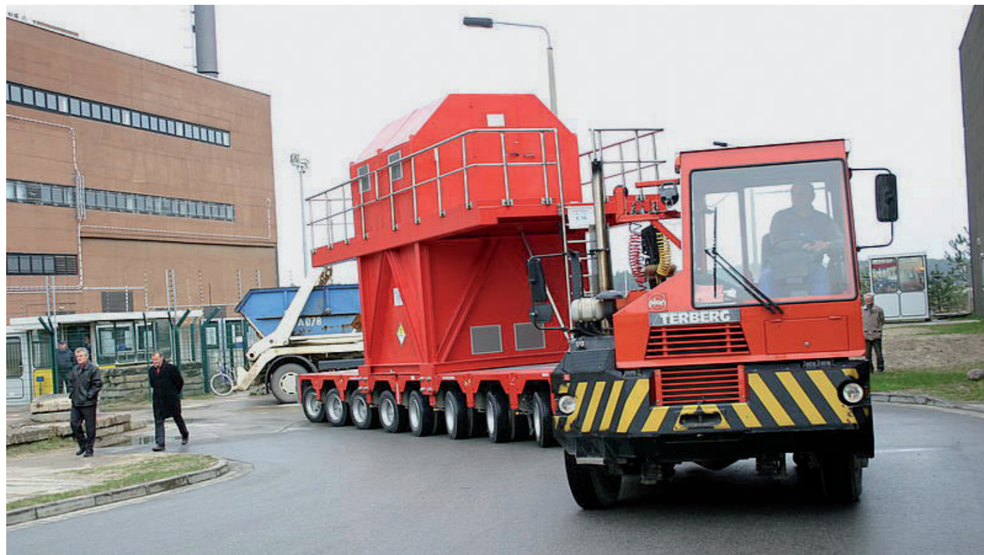
Abb. 21: Innerbetrieblicher Transport bestrahlter Brennelemente
