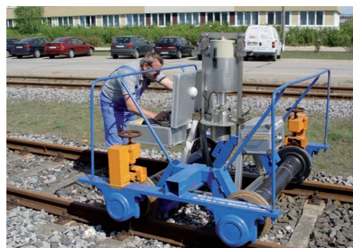
Abb. 37: Messung zur Freigabe von Außenflächen
