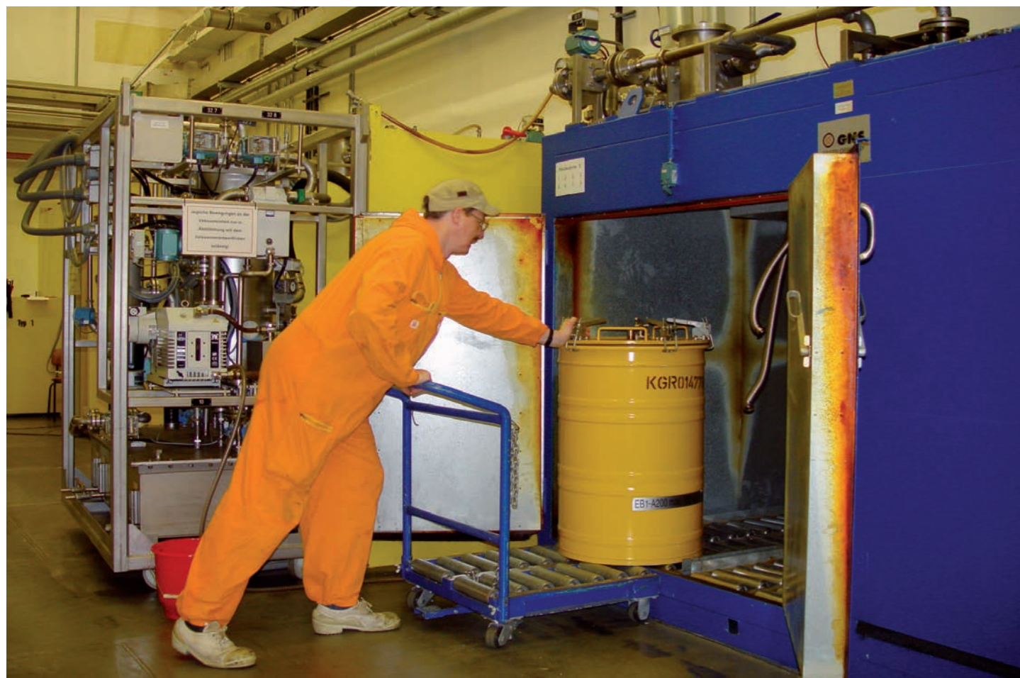
Abb. 41: Konditionierung von Abfällen (Fasrocknungsanlage)
